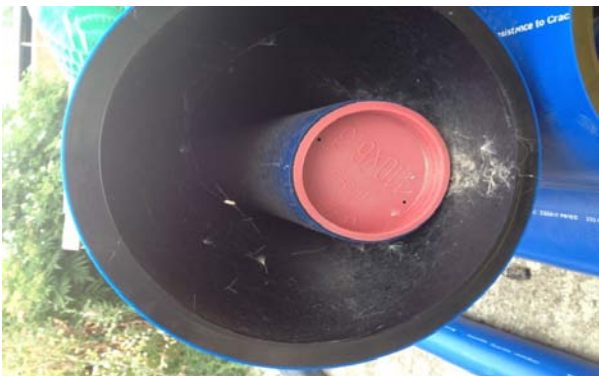
Picture 5 HDPE PIPE PE 100 PN-10 RC PAS 1075
